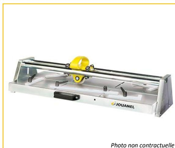
Le coupe-ardoise CA600 est l'outil indispensable pour le travail des ardoises à façon sur le chantier. Son disque renforcé, monté sur guides acier et roulements à billes, assure une excellente régularité de coupe et une manœuvre sans effort.
